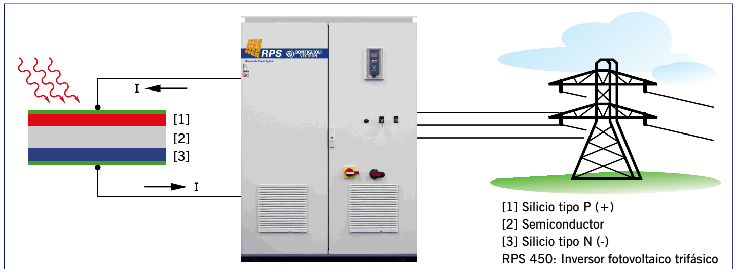
Diagrama del efecto fotoeléctrico. Algunos fotones incidentes son absorbidos por los electrones del medio dotándoles de energía suficiente para escapar de éste.
